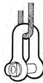
Piegamento della fune su raggio troppo piccolo (in questo caso la portata si riduce a circa il 50%)
