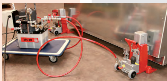
Elektropumpe JPE 30 NVR mit 2 Hebegeräten im Einsatz
