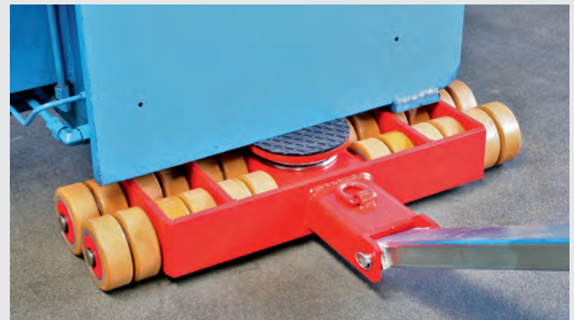
Lenkwerk der G-Serie im Einsatz
