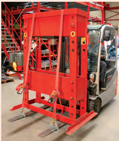
Ladungssicherung mit Gabelklemmen und Spanngurten
